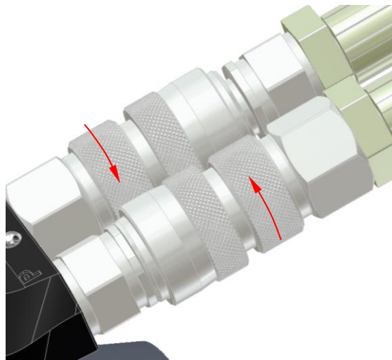
Bloccaggio del raccordo del tubo flessibile idraulico.
